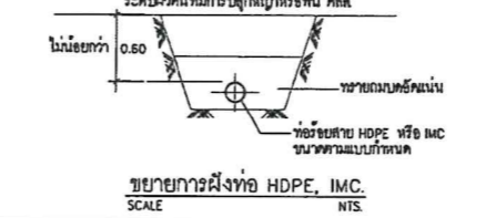
ขยายการฝังท่อ HDPE, IMC SCALE N.T.S.
