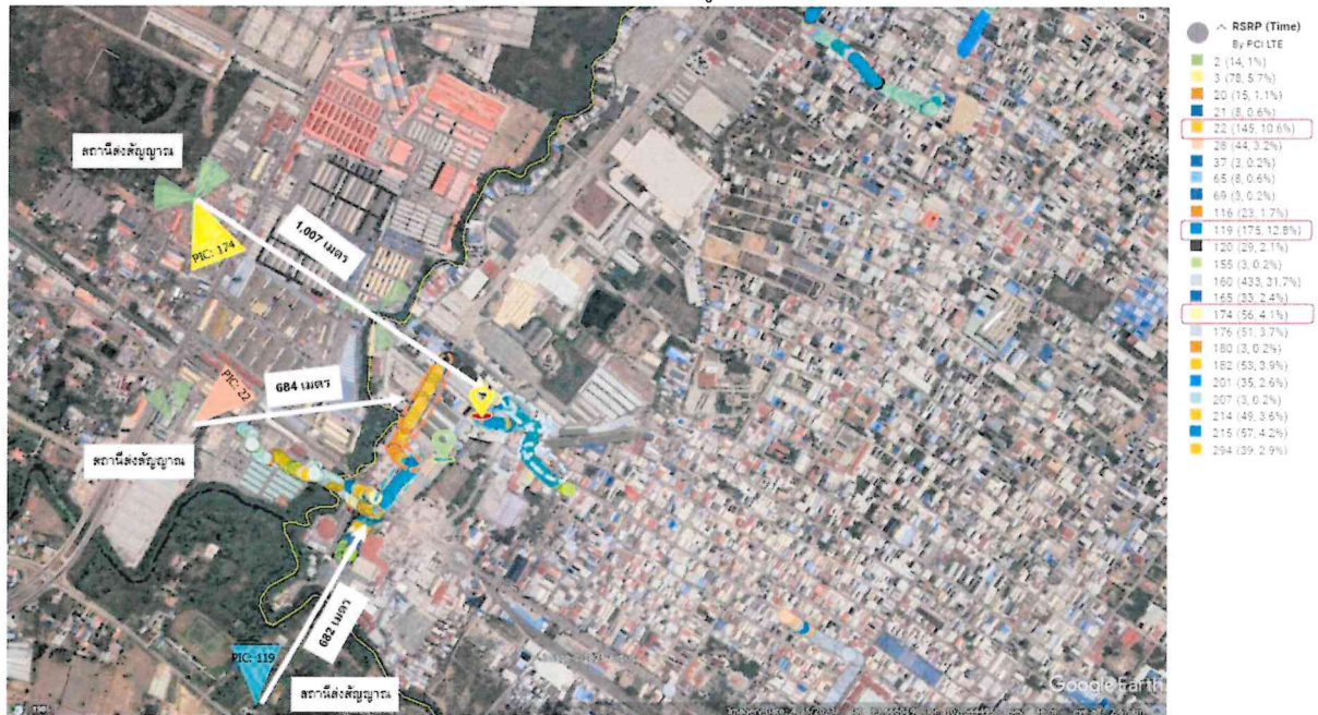
Figure-ExSc-5 แสดงการระบุแหล่งกำเนิดของสัญญาณโดยพารามิเตอร์ PCI_LTE บนแผนที่ภูมิศาสตร์
