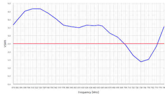
รูปที่ 5 แสดงอัตราส่วนคลื่นนิ่งของสายอากาศรับสัญญาณจำนวน 2 รุ่น บนย่านความถี่ 470 – 790 เมกะเฮิรตซ์
