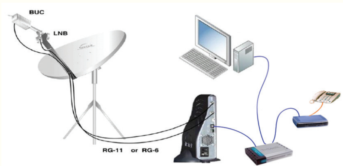
ภาพที่ 41 ภาพการเชื่อมต่อจานสายอากาศและ VSAT เข้ากับอุปกรณ์ต่างๆ
