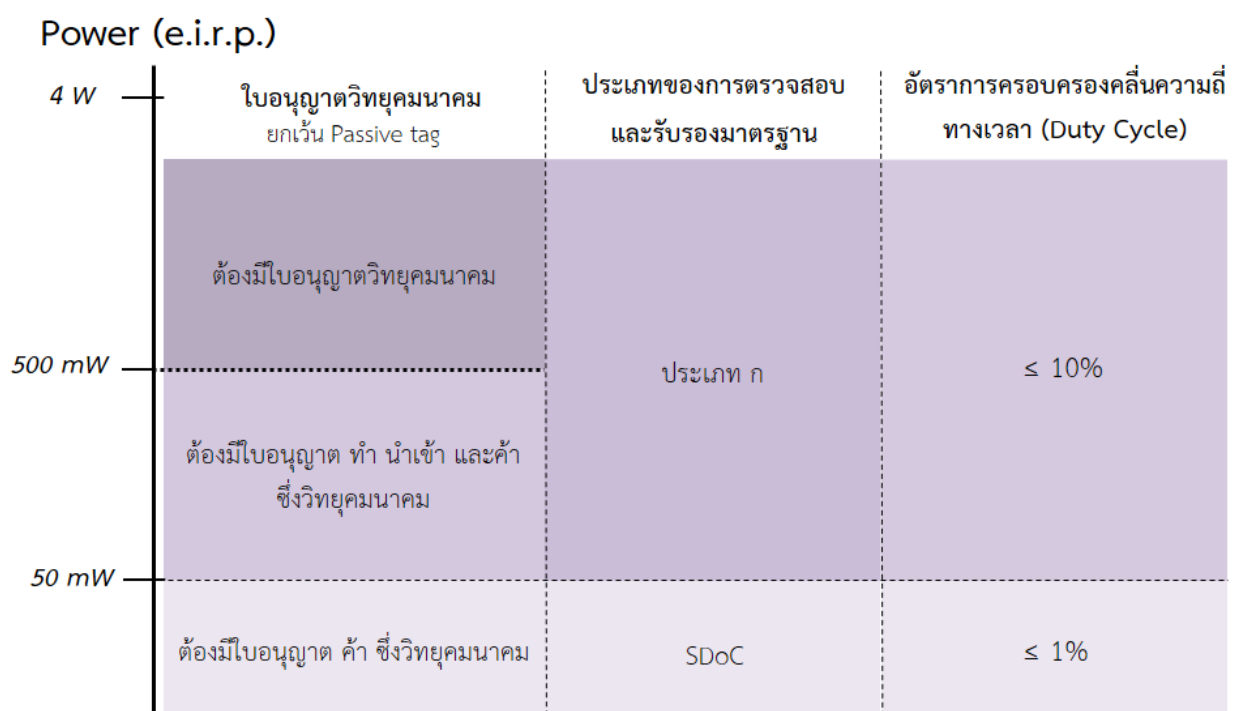
รูปที่ 2.3 หลักเกณฑ์สำหรับการยกเว้นใบอนุญาตวิทยุคมนาคม การแสดงความสอดคล้องทางเทคนิค และการ เข้าใช้คลื่นความถี่ โดยแบ่งตามค่ากำลังส่ง สำหรับเครื่องวิทยุคมนาคมที่ไม่ใช่ประเภท RFID
