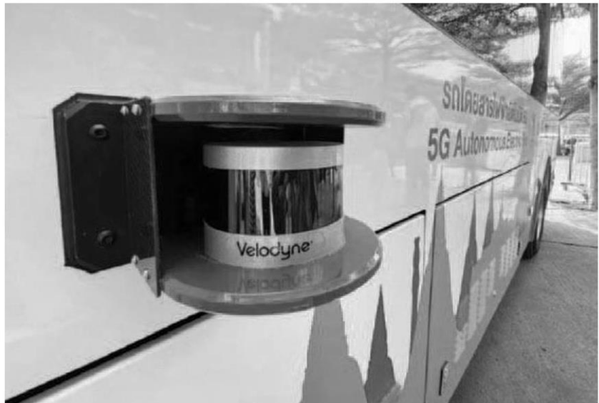
LiDAR เซนเซอร์ตรวจจับวัตถุและวัดระยะด้วยแสงเลเซอร์ 1 ใน 6 ตัวที่ติดอยู่ด้านข้างตัวรถ
