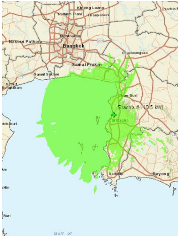
รูปที่ 6 พื้นที่การกระจายเสียงอ้างอิงของสถานีวิทยุคมนาคม Si Racha - N1
